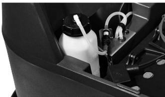
Système de mélange de détergent en option (permet un réglage flexible du détergent ou un nettoyage à l'eau seulement).
