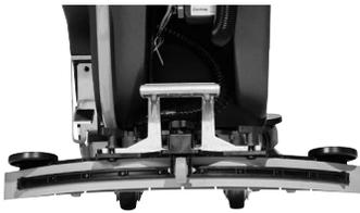
Le système breveté de lame de raclette rend l'entretien rapide et simple grâce au basculement de la lame - quatre bords d'usure.
